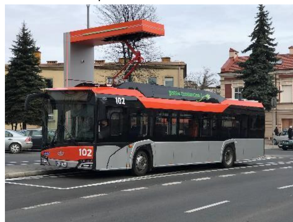
Rys. 2.3 Autobus elektryczny akumulatorowy na stacji szybkiego ładowania w Rzeszowie
