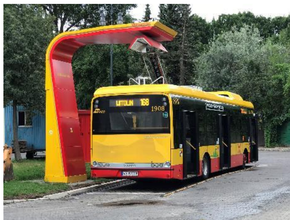
Rys. 4.4 Ładowarka pantografowa i autobus elektryczny akumulatorowy Solaris Urbino 12 electric w malowaniu ZTM Warszawa
