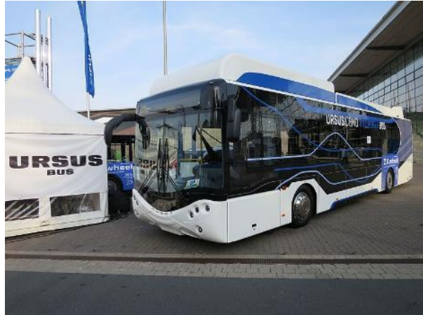
Rys. 2.4 Autobus na ogniwa wodorowe polskiej konstrukcji
