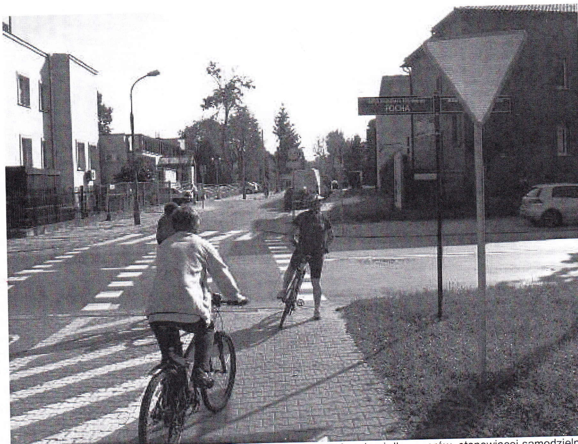
Rys. 5. Wjazd na przejazd dla rowerzystów zlokalizowany na końcu drogi dla rowerów, stanowiącej samodzielny, czwarty wlot skrzyżowania. Pierwszeństwo ustalane znakiem A-7 umieszczonym na wlocie drogi dla rowerów. W tym miejscu powinien znajdować się niewidoczny na zdjęciu znak C-13a („koniec drogi dla rowerów”). Kraków, skrzyżowanie ul. Focha i Kasztelańskiej.
